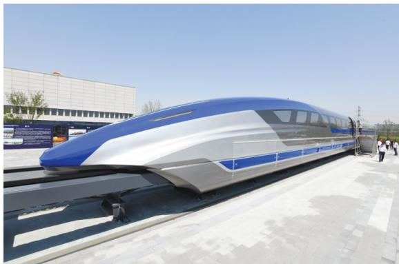
时速600公里高速磁浮试验样车下线
