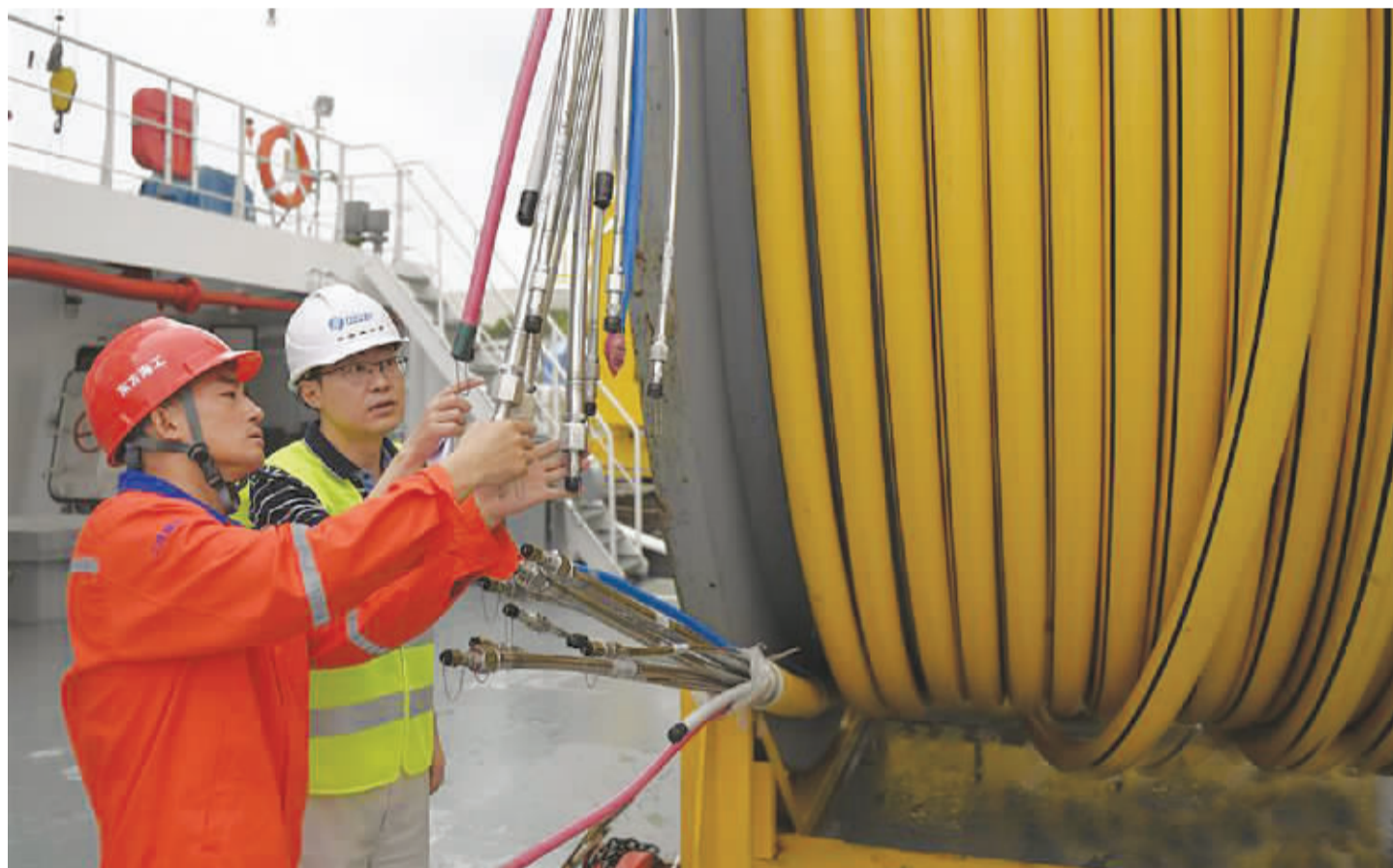
近日，由我国自主研发、设计、制造的首根国产化海洋脐带缆在浙江省宁波市北仑区东方电缆码头交付，即将安装应用于海洋深水油气田群开发项目。此脐带缆设计应用水深500米，总长23.047千米，总重超700吨。据介绍，脐带缆是深水油气气举领域的核心装备，为深水油气田的上部平台控制设施和水下生产系统装备(采油树)之间提供电力、通信、液压力学和化学药剂通道等连接。因为工作人员在查看首根国产化海洋脐带缆的不锈钢管。
