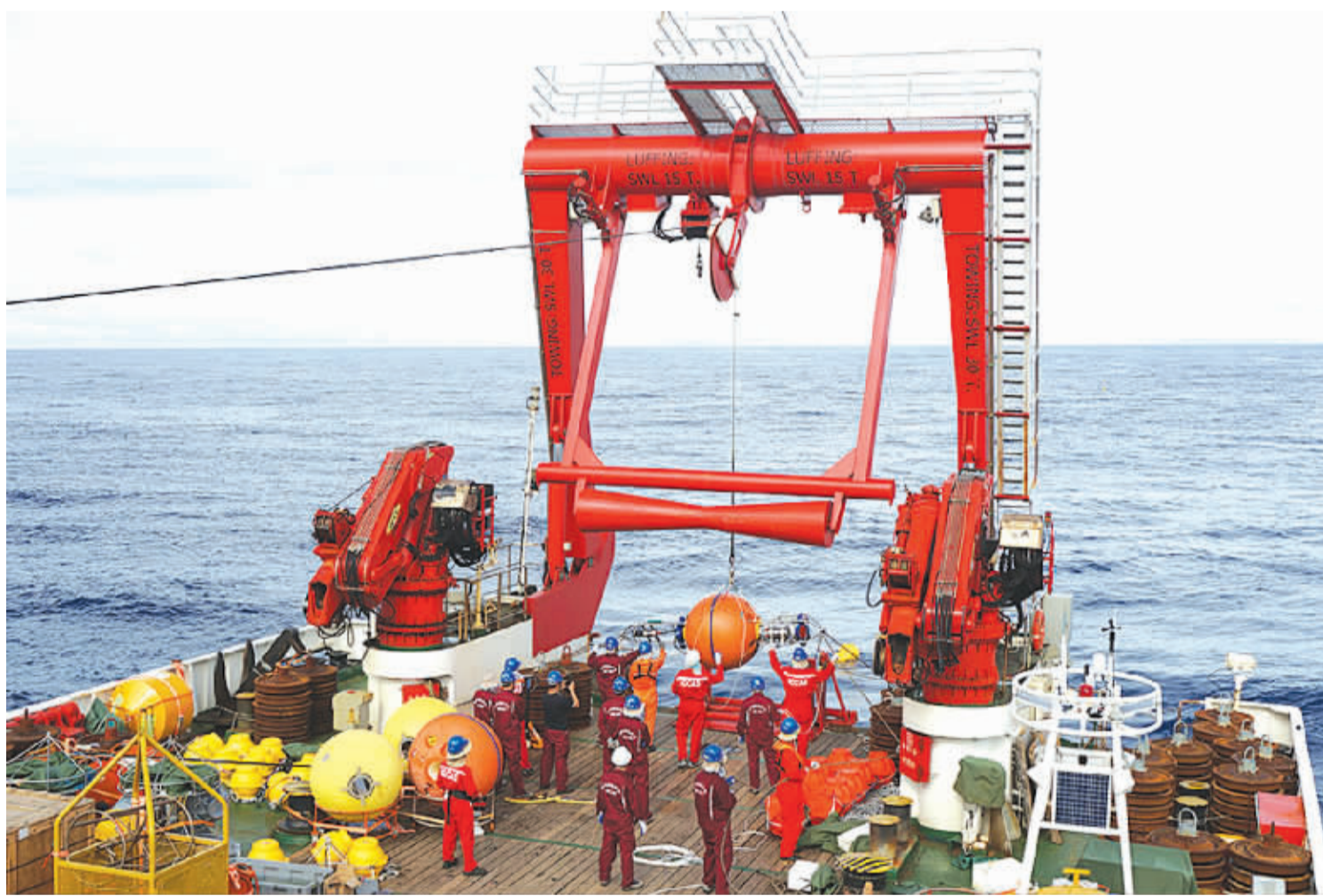
近日,我国新一代海洋综合科考船“科学”号在完成2017年西太平洋综合考察航次后,返回青岛西海岸新区的母港。科考队员在本航次成功建成我国首个深海实时科学观测网,西太平洋深海3000米范围内的温度、盐度和洋流等数据实现1小时1次实时传输。图为科考队员在布放潜标。
